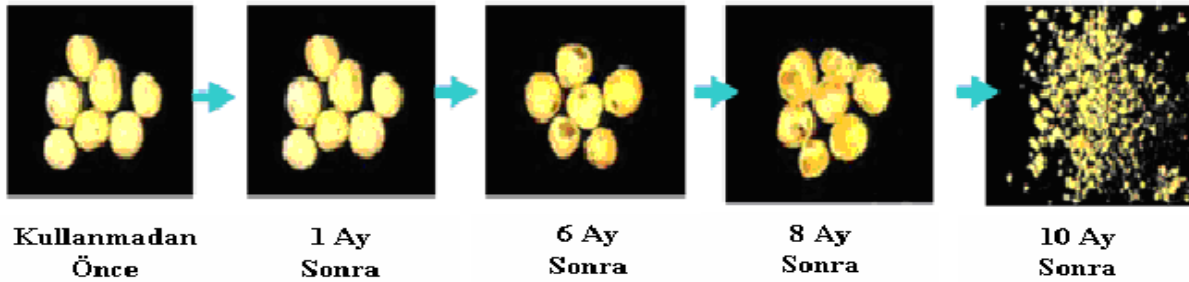
Şekil 5. Kükürt ve polimer-wax ile kaplanmış gübrenin zamanla parçalanması (Yunfeng, 2007).
