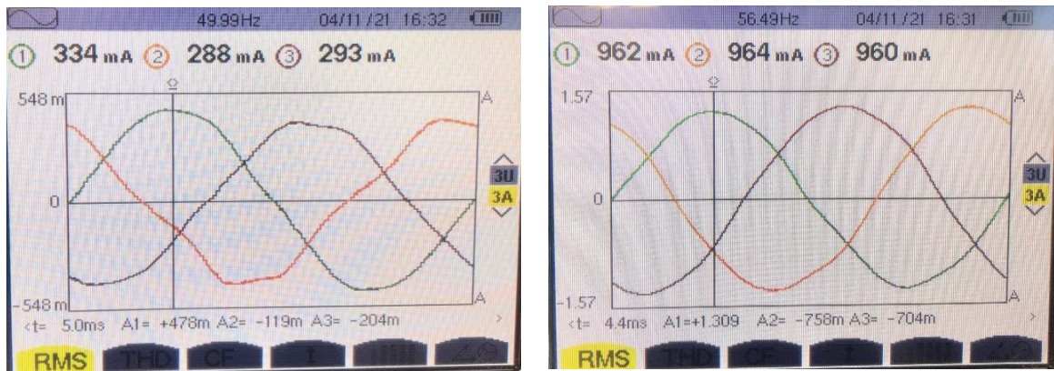
Şekil 9. Farklı Hızlar İçin Ölçülen Motor 3 Faz Akımları (1500dev/dak-17000dev/dak)
