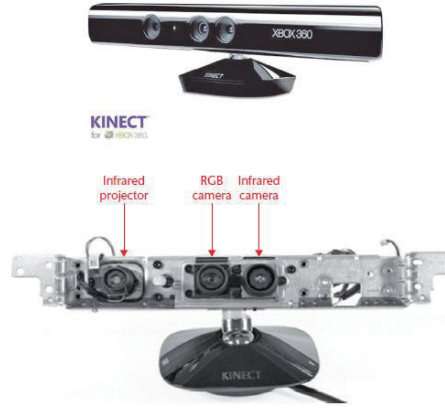
Şekil 2. Kinect Xbox 360 Sensörü ve Yapısı
